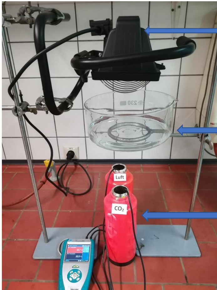
Versuchsaufbau zur Messung des Temperaturanstieges in den Gefäßen Henker (eigenes Foto)
